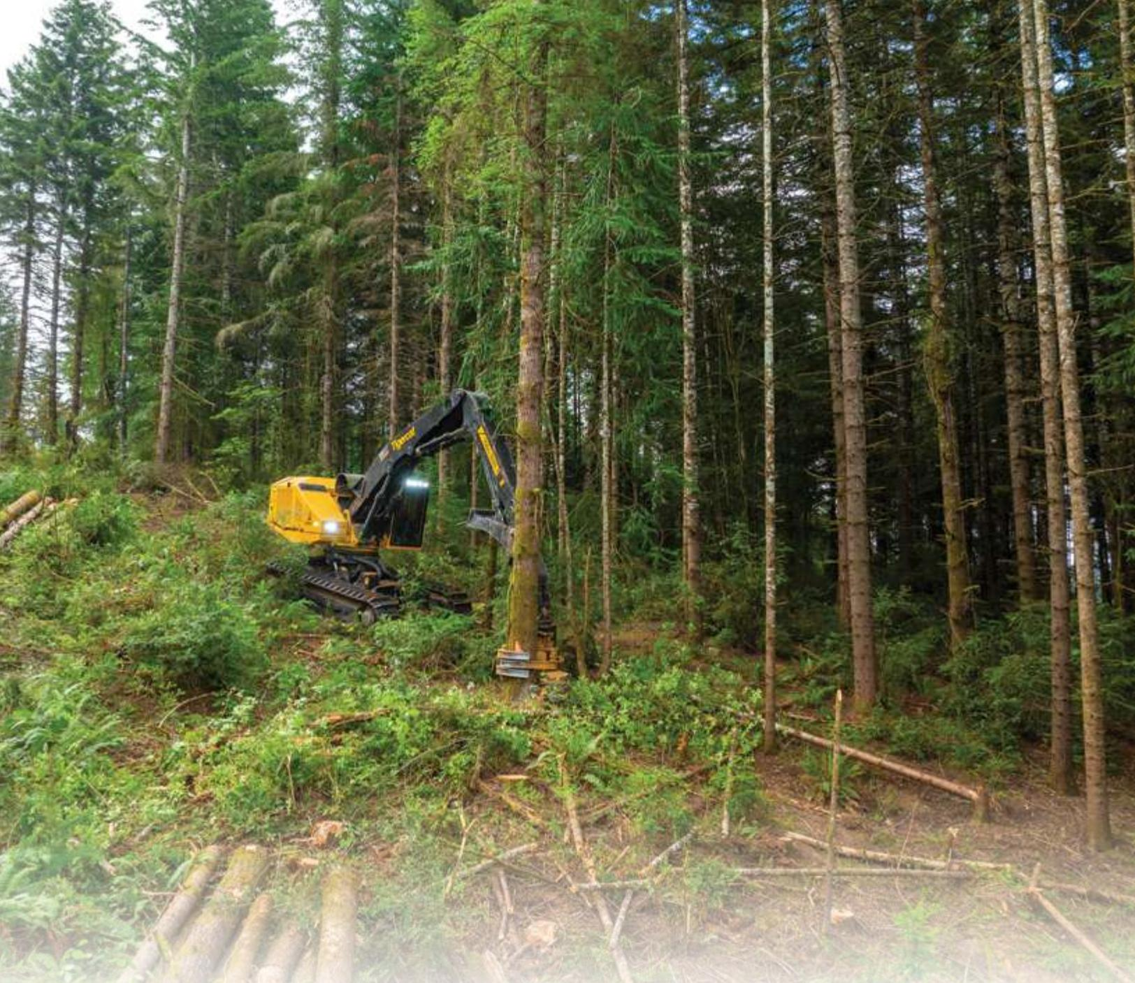
O LS857 É UM SHOVEL LOGGER DE ALTO DESEMPENHO PARA TERRENOS MUITO INCLINADOS COM UM PERFIL EXCLUSIVO, PROPORCIONANDO MAIOR CAPACIDADE DE NIVELAMENTO E MELHOR GERENCIAMENTO DE CABOS PARA OPERAÇÕES ASSISTIDAS POR GUINCHO. ELE PREENCHE A LACUNA ENTRE A COLHEITA CONVENCIONAL EM SOLO E OS SISTEMAS DE BALDEIO.
